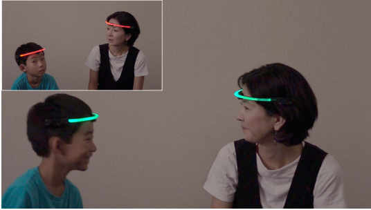
図 1 複数人による双方向の対面行動を計量する頭部装着型デバイス
